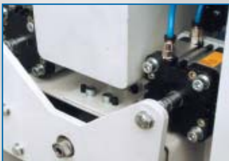
Pneumatic oscillation brush Pneumatische oscillation der Bürste Pneumatiká oscilace kartáče
