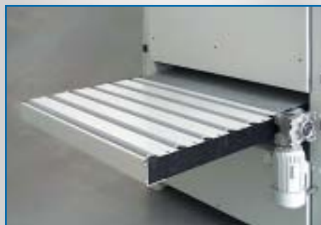
Prolonged table with rollers 0,5 m (1,2 m) Tischverlängerung mit Walzen 0,5 m (1,2 m) Prodłużenie stołu s wálkami 0,5 m (1,2 m) Przedłużenie stołu z dwiema rolnkami 0,5 m (1,2 m) Удлинение стола с двумя накатными роликами 0,5 м (1,2 м)
