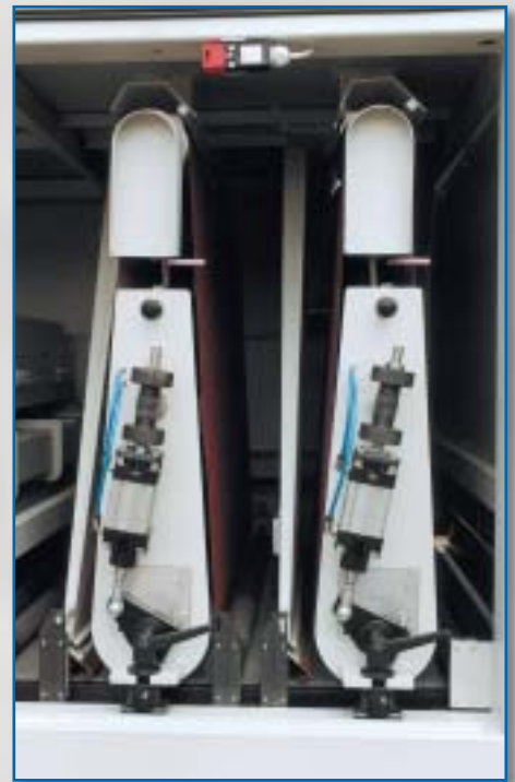
Pneumatic control height of the rollers Pneumatische Steuerung Höhe Kontaktwalze Pneumatiké zvedání brusných válců
