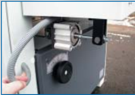
Automatic conveyor belt centering Automatische Zentrierung des Vorschubbandes Automatické centrování podávacího pásu Automatycznie centrowanie taśmy Автоматическое центрирование подающей ленты
