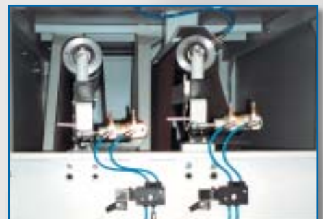
Belt oscillation • Oszillation Oscilace • Oscylacja Осциляция
